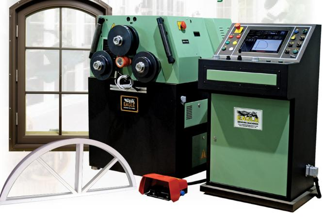
SUPERIOR SERVO CONTROLLED ROLL BENDING
